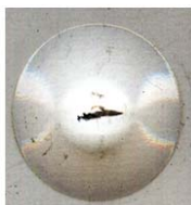
Испытание прочности металлов толщиной от 0,2 мм до 2,0 мм
